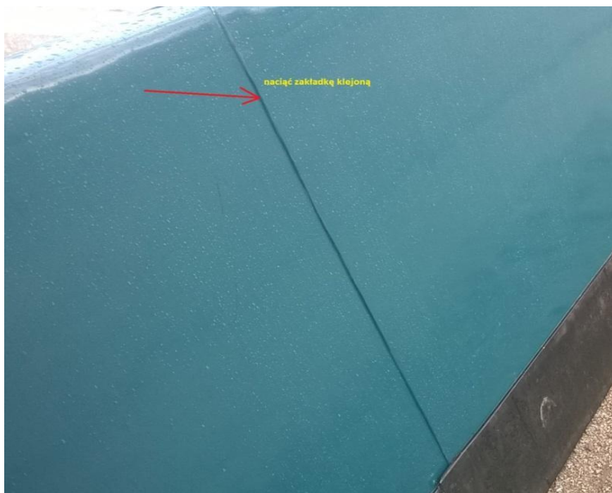
rys. 3. Miejsce nacięcia w przypadku wymiany całego elementu
